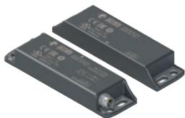
Die magnetkodierte Sensoren dienen zur Überwachung von Absicherungen und Schutzeinrichtungen von Maschinen ohne Nachlauf. Verbunden mit einem Sicherheits-Modul kann ein System bis Sicherheits-Kategorie SIL 3 gemäß EN 62061, bis PL e gemäß EN ISO 13849-1 und bis Kategorie 4 gemäß EN ISO 13849-1 aufgebaut werden.
