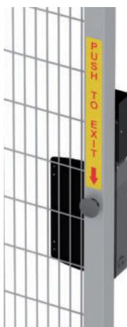
Gelber Polycarbonataufkleber, rechteckig 300x32 mm, rote Beschriftung. Wird auf der Innenseite des Türpostens aufgeklebt, zur Kennzeichnung des Fluchtentsperrungstasters.
