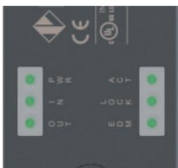
Für eine sofortige Diagnose des Sensorzustands sorgen LEDs, die den Zustand jedes Ein- und Ausgangs anzeigen. So kann eine Unterbrechung der Sicherheits-Kette schnell erkannt werden: welches Gerät entriegelt wurde, welche Schutzvorrichtung geöffnet ist, sowie evtl. interne Gerätefehler. All dies auf einen Blick, ohne komplexe Blinksequenzen entschlüsseln zu müssen.
