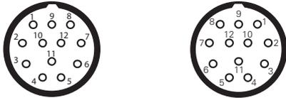
Nummerierung im Uhrzeigersinn      Nummerierung gegen den Uhrzeigersinn
