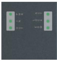
Für eine sofortige Diagnose des Sensorzustands sorgen LEDs, die den Zustand jedes Ein- und Ausgangs anzeigen. So kann eine Unterbrechung der Sicherheits-Kette schnell erkannt werden: welches Gerät entriegelt wurde, welche Tür geöffnet ist, sowie evtl. interne Gerätefehler. All dies auf einen Blick, ohne komplexe Blinksequenzen entschlüsseln zu müssen.
