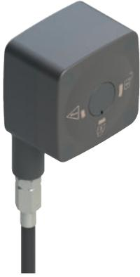
Die Fern-Fluchtentsperrung (remote escape release) wird über ein flexibles Kabel betätigt. Sie ermöglicht die Entriegelung des Sicherheits-Schalters aus der Ferne, für Anwendungen bei denen übliche Hilfsentsperrungen (per Schloss, Schraubendreher, Taster usw.) aufgrund der Maschinenkonfiguration nicht leicht erreichbar sind.
