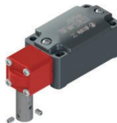
Bei der Installation des Geräts kann der Schalterpunkt der Kontakte über den gesamten Bereich von 360° eingestellt werden. Mit der mitgelieferten Madenschraube kann die korrekte Einstellung des Betätigungswinkels überprüft und ggf. einfach und schnell geändert werden. Nach Abschluss der Einstellarbeiten schützt man das Gerät mit dem mitgelieferten Blockierstift vor Manipulationen mit Hilfe von üblichen Werkzeugen.
