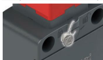
Die Schalter mit verriegeltem Betätiger bei deaktiviertem Elektromagnet (Funktionsprinzip D) sind mit einer Hilfsentsperrung des Elektromagneten ausgestattet, um die Installation des Schalters zu erleichtern und um bei Spannungsausfall in
