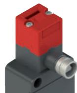
Die Hilfsentriegelung mit Schloss ist auch mit Option V73 erhältlich, eine Variante mit Dreikantschlüssel gemäß DIN 22417. Diese Option kann bei Installationen verwendet werden, bei denen die Hilfsentriegelung mit einem Dreikantschlüssel betätigt werden soll, der normalerweise nicht allgemein verfügbar ist.
