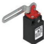
Diese Sicherheits-Schalter sind ideal zur Überwachung von Toren oder Schutzvorrichtungen mit Scharnier, die gefährliche Teile von Maschinen ohne Nachlauf absichern. Sie sind leicht zu installieren und müssen mit dem Scharnier der Schutztür nicht interagieren. Sie sind sehr sensibel, öffnen die Kontakte zwangsgeführt nach wenigen Graden der Drehbewegung und senden sofort das Stoppsignal.
