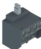
Innovative Kontakteinheit mit 4 Kontakten, erhältlich in verschiedenen Kontaktkonfigurationen zur Überwachung des Betätigers oder des Elektromagneten (patentiert). Die Einheit ist mit unverlierbaren Schrauben und selbsthebenden Drahtklemmplatten ausgestattet. Abnehmbarer Fingerschutz für Quetschkabelschuh.
