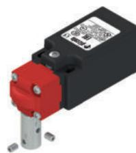
Bei der Installation des Geräts kann der Schalterpunkt der Kontakte über den gesamten Bereich von 360° eingestellt werden. Mit der mitgelieferten Madenschraube kann die korrekte Einstellung des Betätigungswinkels überprüft und ggf. einfach und schnell geändert werden. Nach Abschluss der Einstellarbeiten schützt man das Gerät mit dem mitgelieferten Blockierstift vor Manipulationen mit Hilfe von üblichen Werkzeugen.
