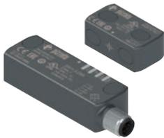
Die Sensoren der Serie ST D sind in Verbindung mit den entsprechenden Sicherheits-Modulen für die Überwachung von Schutzvorrichtungen von Maschinen ohne Nachlauf geeignet und ermöglichen dem System, in dem sie eingesetzt werden, eine Sicherheits-Kategorie bis zu SIL 3 gemäß EN 62061, sowie bis zu PL e und Kategorie 4 gemäß EN ISO 13849-1 zu erreichen.
